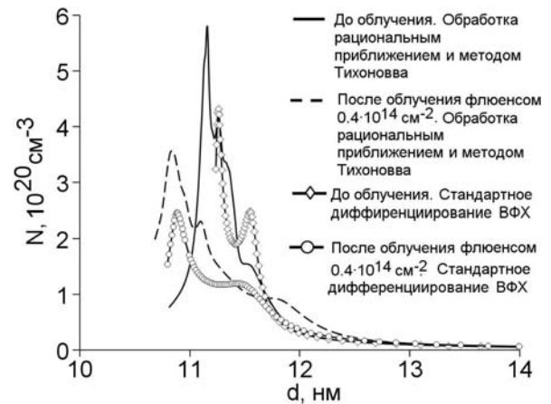
Рис. 1. Результаты расчетов профилей распределения электронов в GaN НЕМТ до и после облучения нейтронами флюенсом 0.4 \cdot 10^{14} \text{ см}^{-2} с использованием рационального приближения и метода Тихонова 1-го порядка и полученные стандартным методом [3]
