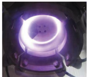
Магнетрон «МАГ-2000» сплошность пленок от 1 нм скорость роста 0.1нм/с поставка со склада
