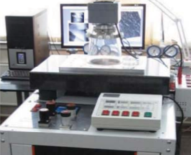
Напылительный STM/AFM наблюдение роста пленок и наночастиц в процессе магнетронного напыления нет аналогов в мире
