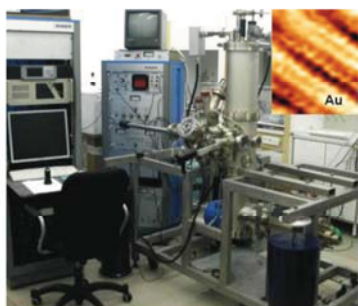
UHV-Крио-STM 5К - 300С, атомное разрешение разработан совместно с ИОФАН
