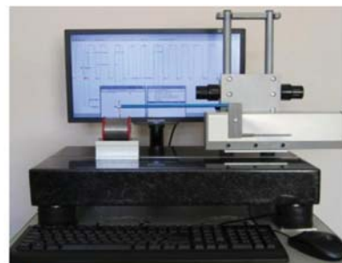
Контурограф модели 220 оцифровка формы образцов с точностью до 1 нм, трасса до 220 мм режимы кругломера и профилометра Госреестр, поставка со склада
