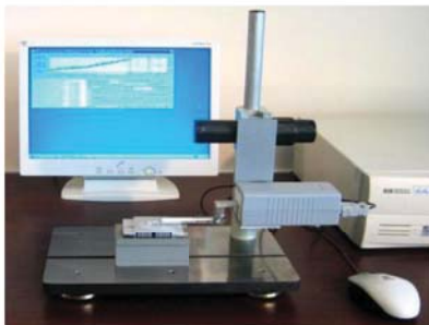
Профилометр модели 130 28 параметров шероховатости точность 1 нм, трасса 12,5 мм 1-14 классы шероховатости Госреестр, поставка со склада
